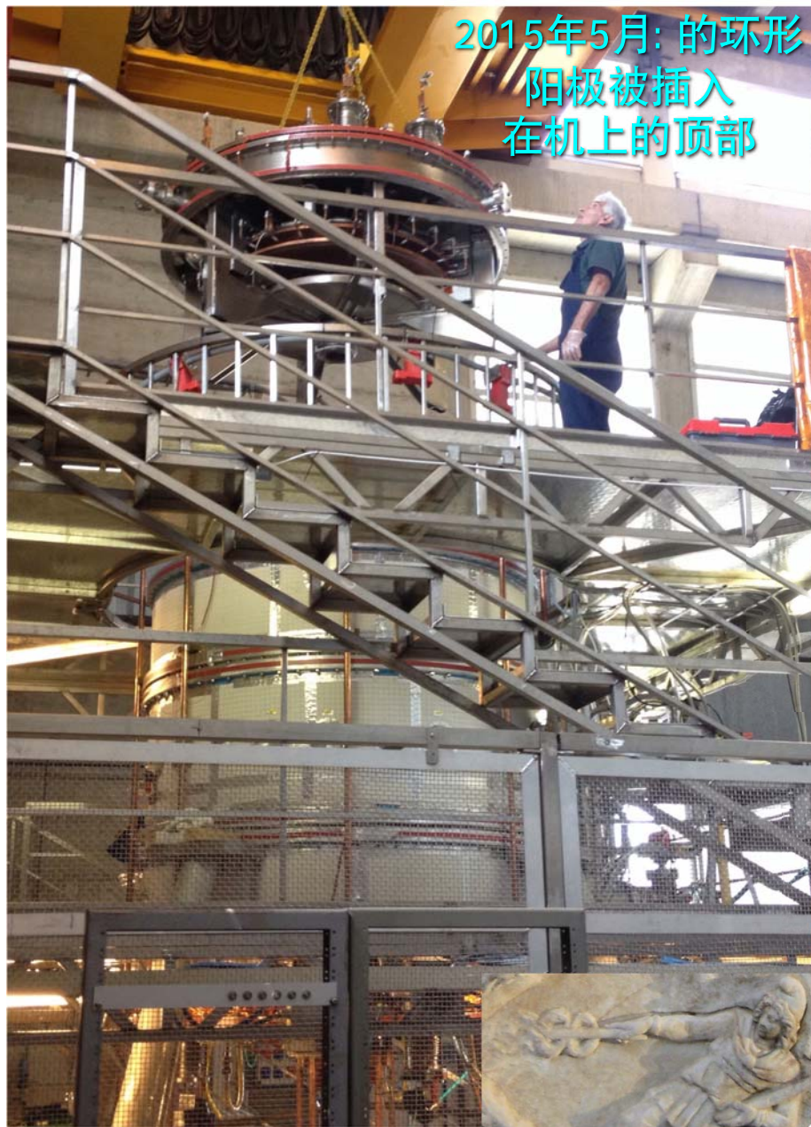
最后阶段阴极, 6 × 现阶段 (108×3的发射灯丝): 目标60kA
