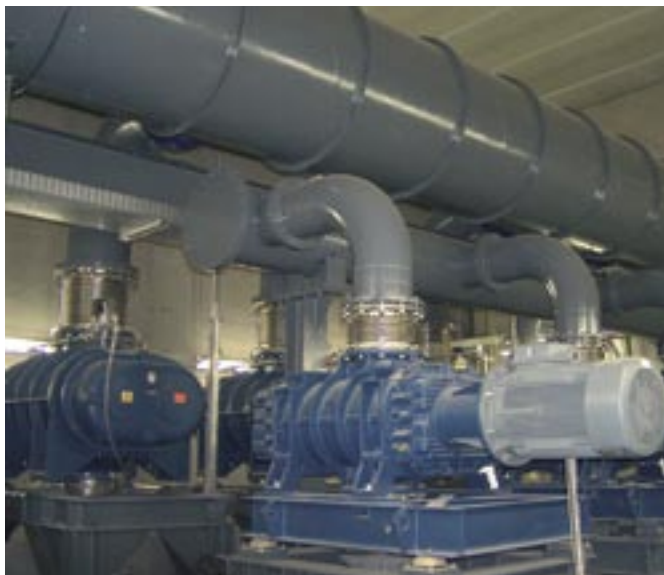
▲ Impianto per vuoto a 4 stadi con portata 2 x 30.000 m 3 /h nel degassaggio dell'acciaio ▼
