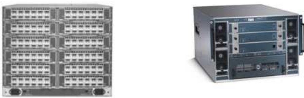
Figura 14 - Front e Back plain del Cisco SFS 7012d
